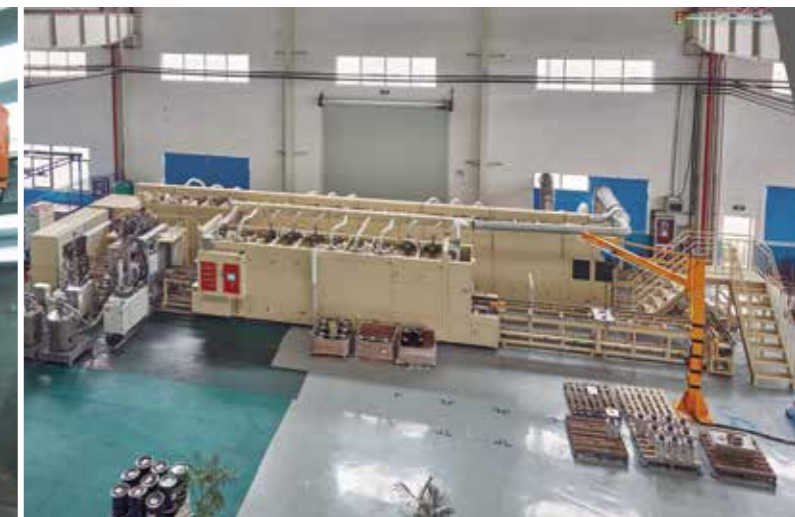
环氧树脂真空浇注自动流水线
