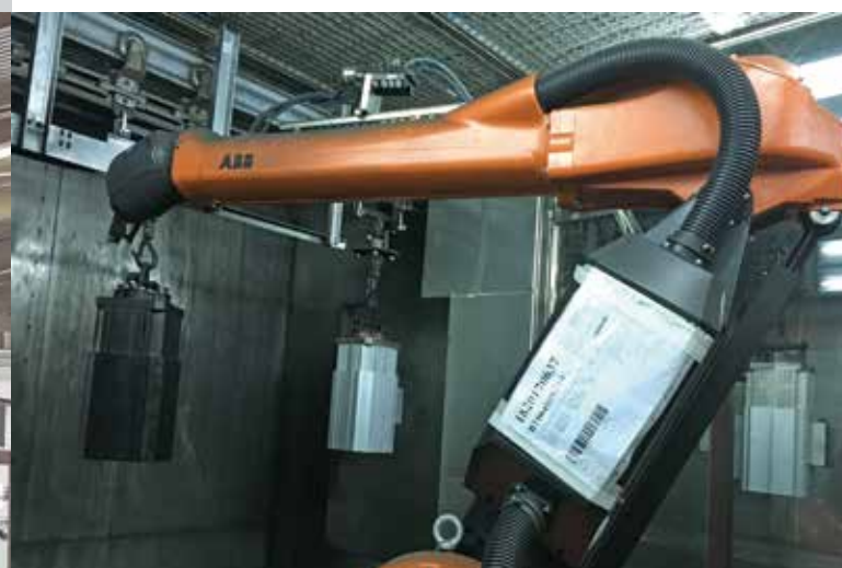
机器人自动喷漆流水线
