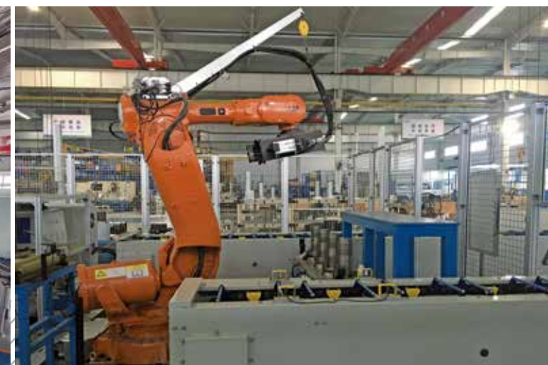
机器人机壳热套流水线
