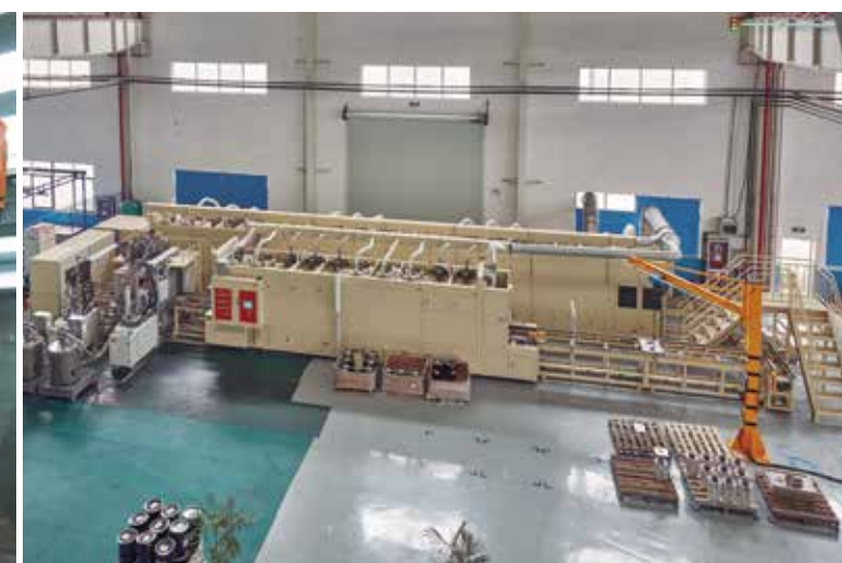
环氧树脂真空浇注自动流水线
